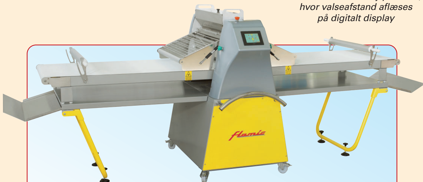
Automatisk Rullebord Flamic Fast med Touchbetjening – automatisk meldrys. Automatisk afslutning / oprulning. Båndbredde: 700 mm Båndlængde: 2000 mm
